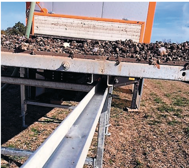
Abb. 12: Ausmisten des Mobilstalls. Systembedingt können viele Arbeiten im Mobilstall nicht automatisiert werden
