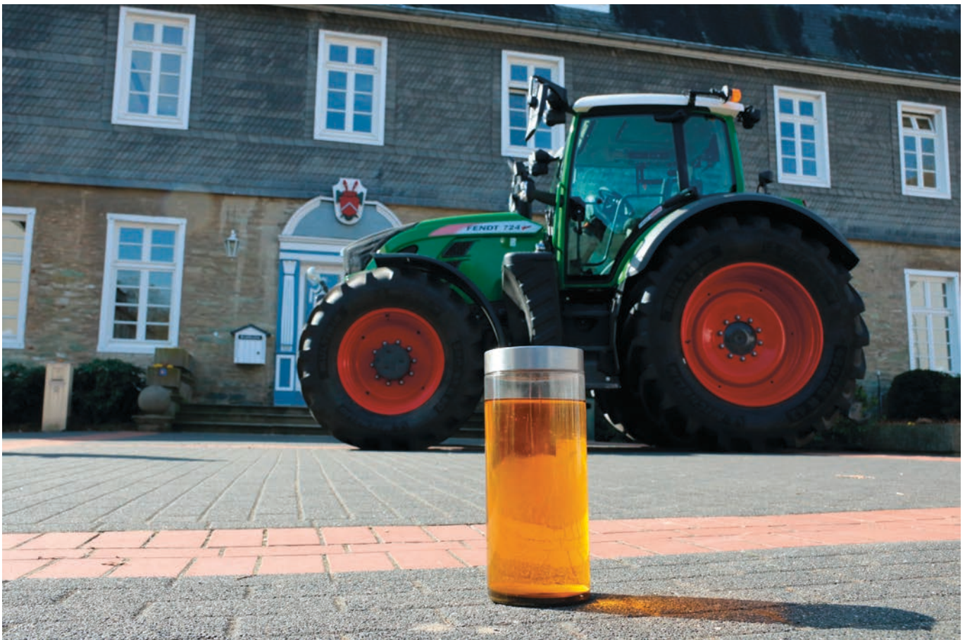
Abbildung 30: Auf Rapsölantrieb umgerüsteter Ackerschlepper
