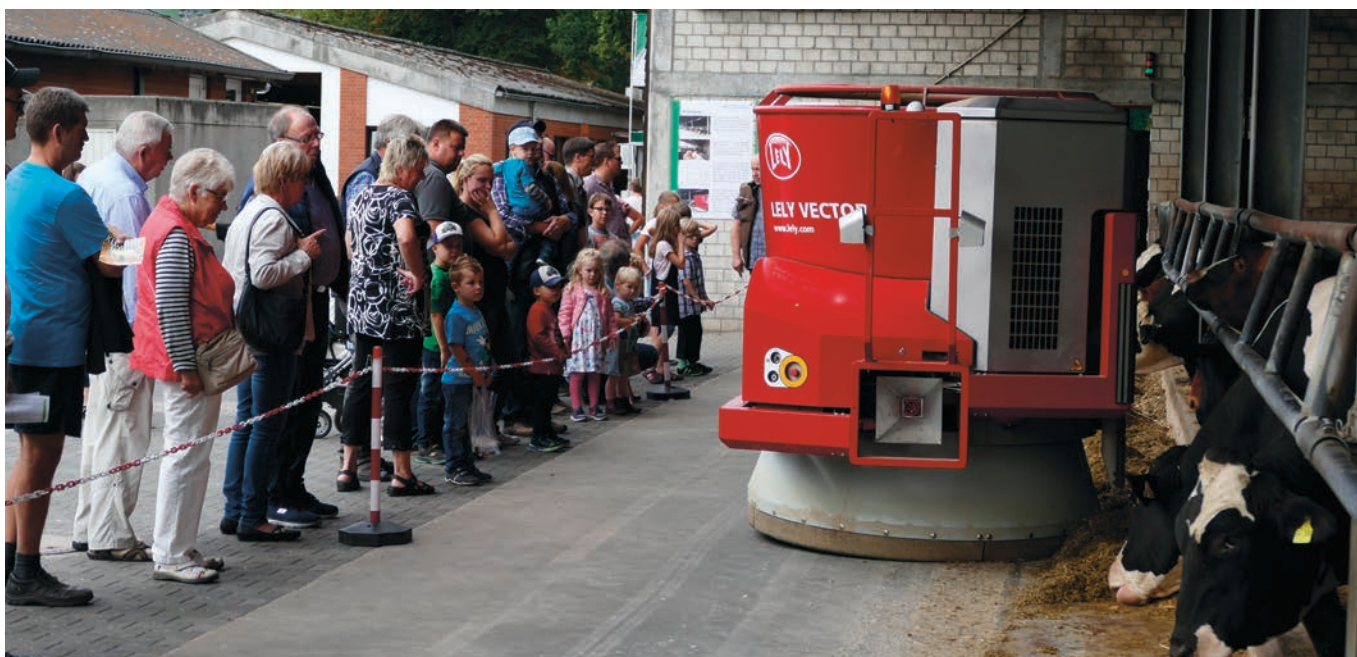
Abbildung 22: Autonom fahrender Fütterungsroboter
