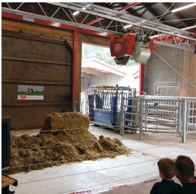
Abbildung 21: Futterküche mit Hallenkran zur Befüllung des Roboters
