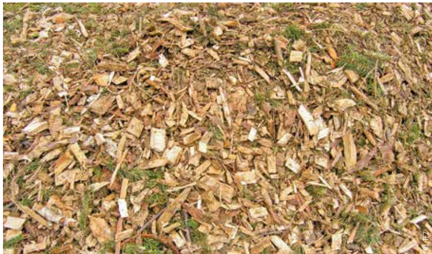
Abb. 11: Hackschnitzel aus Waldrestholz mit Nadeln, Rinde und feinen Ästen. Aschegehalt < 3 Masse-%, Qualität Klasse B, für den emissionsarmen Betrieb von Kleinfeuerungen nicht geeignet.
