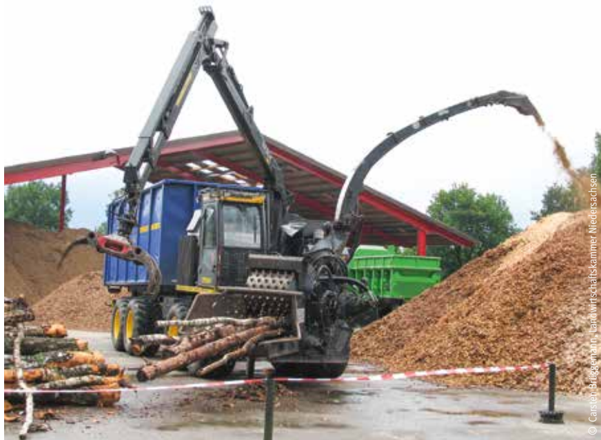
Herstellung von Holzhackschnitzeln auf dem Biomassehof
