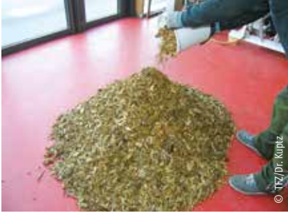
Die Teilproben werden auf einem sauberen, ebenen Untergrund zu einer Gesamtprobe vereint.
