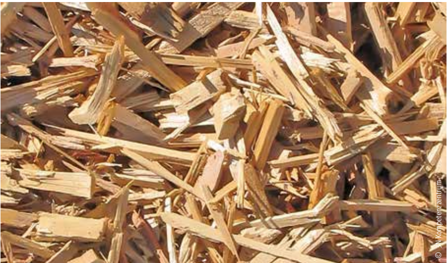
Abb. 16: Hackschnitzel, rindenfrei, aber geschreddert (keine glatten Schnittkanten), für den emissionsarmen Betrieb von Kleinfeuerungen nur bedingt geeignet.
