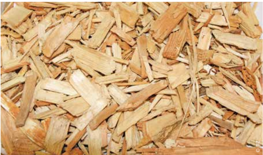
Abb. 8: Hackschnitzel P45S, Kiefer, wenig Rinde, wenig Feinanteil. Aschegehalt 0,4 Masse-%, Qualität Klasse A1
