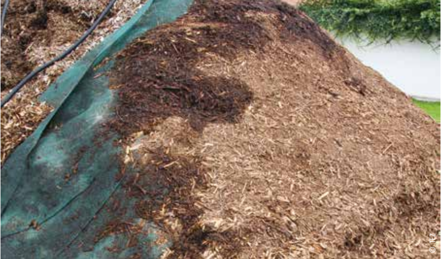
Abb. 15: Deutlich sichtbare Feuchtenester und hohe Feianteile im Hackschnitzelhaufen, für den emissionsarmen Betrieb von Kleinfeuerungen nicht geeignet.
