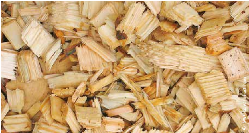
Abb. 7: Hackschnitzel ohne Rinde, Nadeln, Blätter oder feine Äste. Aschegehalt < 1 Masse-%, sehr geringer Feinanteil, Qualität Klasse A1
