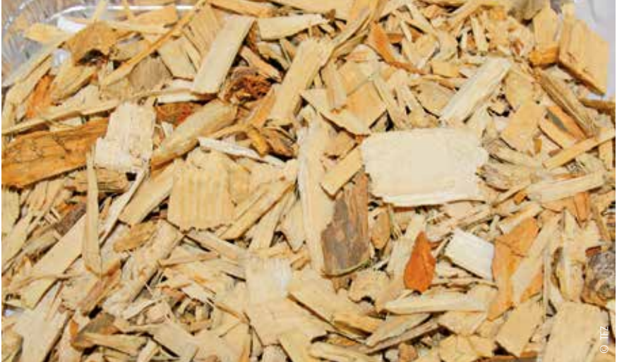
Abb. 9: Hackschnitzel P31S, Kiefer, mäßig viel Rinde, wenig Feinanteil. Aschegehalt 1,5 Masse-%, Qualität Klasse A2
