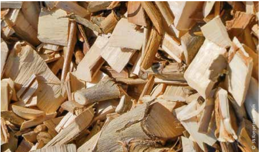
Abb. 10: Hackschnitzel aus Kurzumtrieb ohne Blätter, mit Rinde und feinen Ästen. Aschegehalt < 2 Masse-%, für den emissionsarmen Betrieb von Kleinfeuerungen nur bedingt geeignet.
