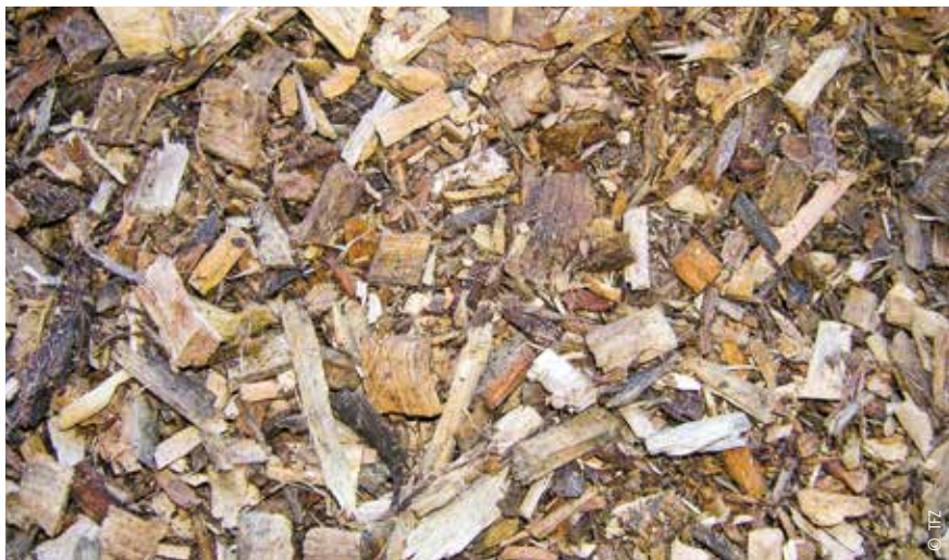
Abb. 14: Hackschnitzel mit hohen Rindenanteilen und Anzeichen von Verrottung und Schimmelbildung, für den emissionsarmen Betrieb von Kleinfeuerungen nicht geeignet.
