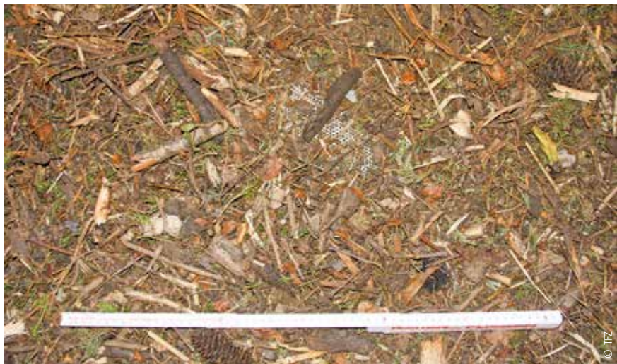
Abb. 12: Hackschnitzel mit Nadeln, Rinde, feinen Ästen und deutlichen Verunreinigungen mit Mineralboden. Aschegehalt > 10 Masse-%, für den emissionsarmen Betrieb von Kleinfeuerungen nicht geeignet.
